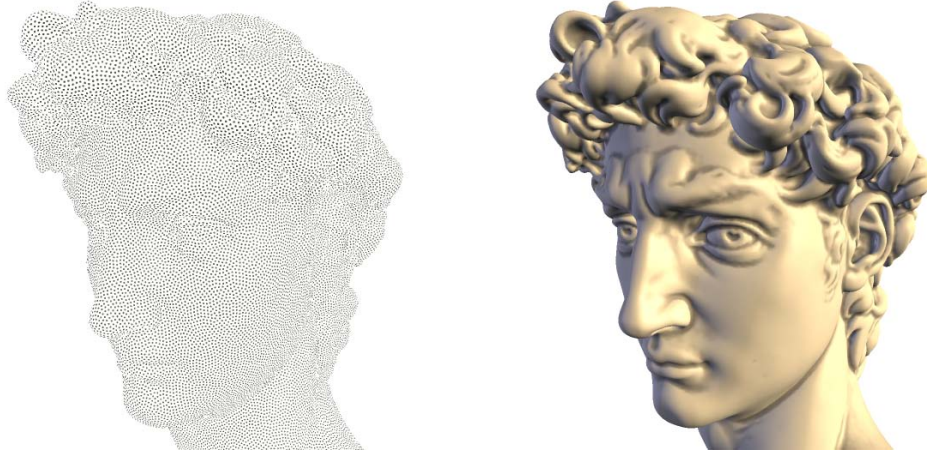
FIGURE 1.13 – Reconstruction d’un nuage de points avec les PSS. La méthode employée est celle de Guennebaud et al. [2008].
